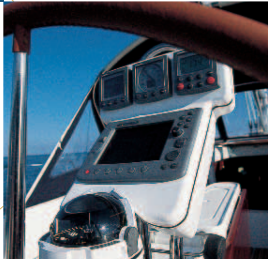
Rueda de timón pivotante (patente Bénéteau) y consola de rueda para la electrónica.
